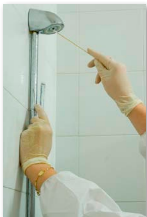
Presca de mostra per a la determinació de legionel·la en un circuit d'aigua calenta sanitària. Font: ARCA, ASPCAT.
