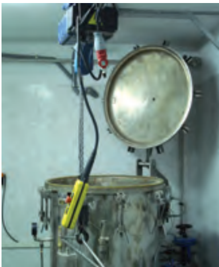
Equip d'autoclau per a esterilització de producte
