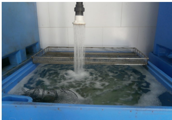
Ducha que favorece la oxigenación del agua del sistema.
