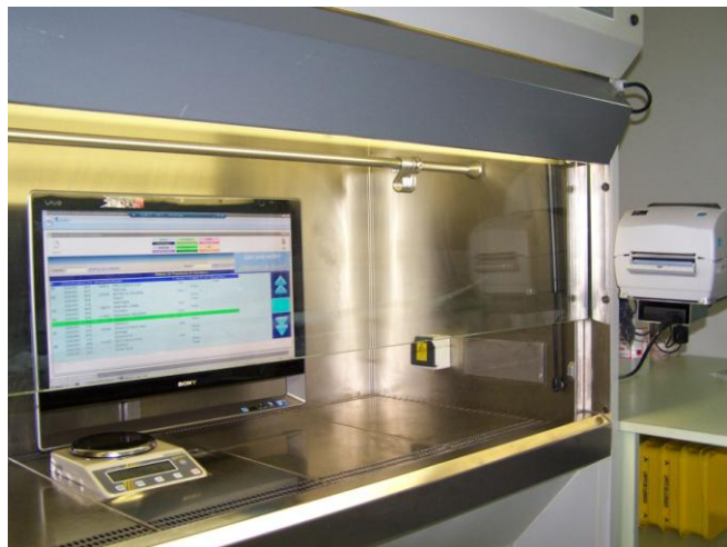
Figura 1. Càmera de flux laminar vertical adaptada.
